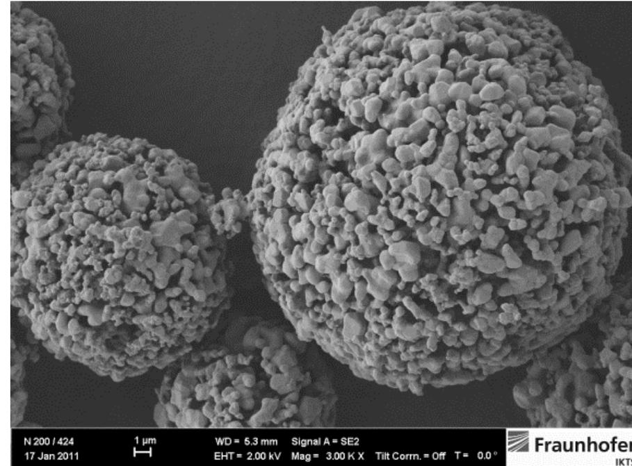
Komplexe Partikel für Lithium-Batterie-Elektroden
