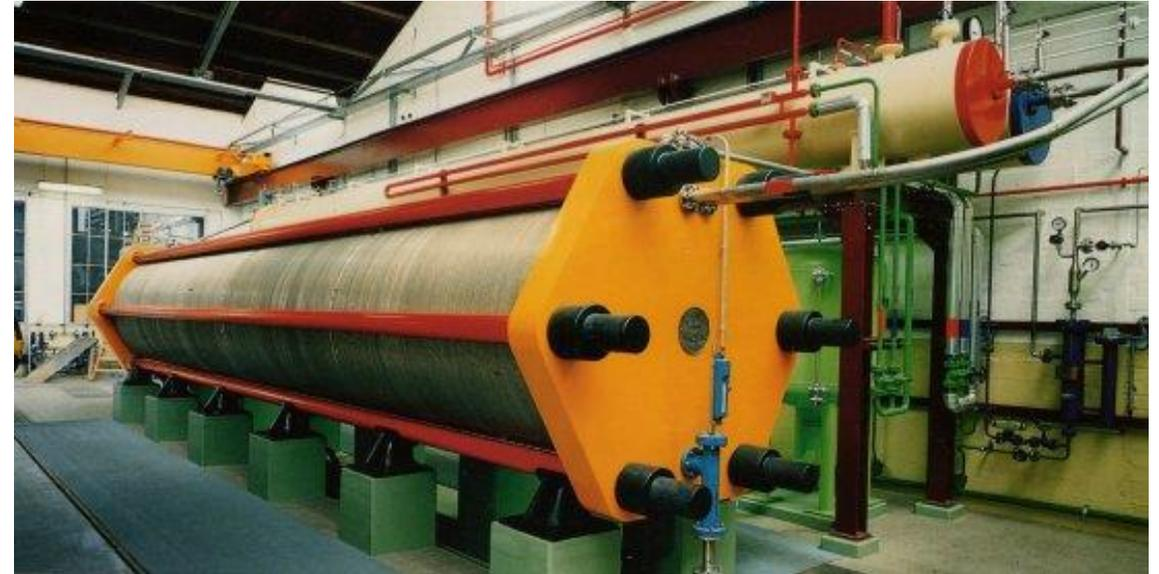
PEM-Elektrolyse Kapazität: 760 Nm<sup>3</sup> H<sub>2</sub>/h 40 bar
