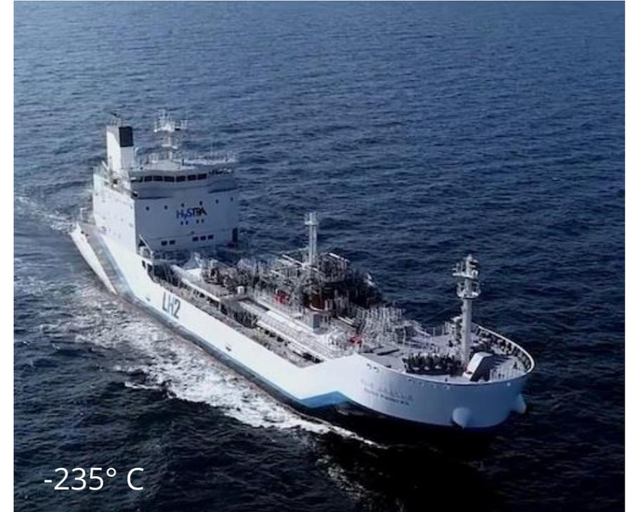
Die Suiso Frontier, hier noch auf der Werft von Kawasaki Heavy Industries in Kōbe, ist weltweit das erste Schiff, das Flüssigwasserstoff über See transportieren kann.
